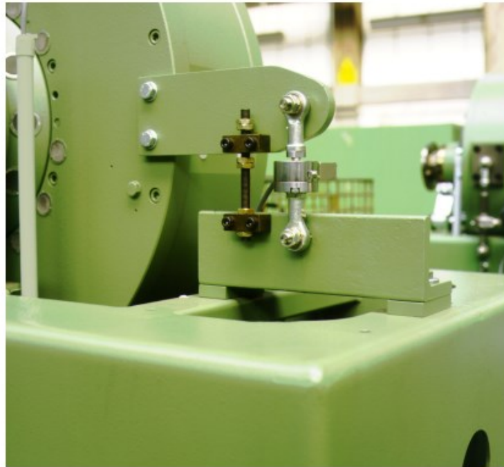
شکل 2: استفاده از مبدل نیرو جهت اندازه گیری نیروی واکنشی روی بازوی اهرمی
